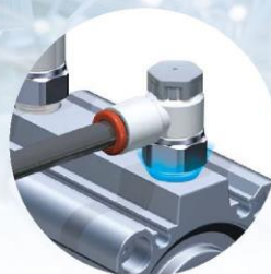
Nieszczelności połączeń gwintowanych z powodu złego stanu instalacji
